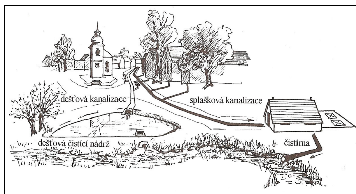
Obrázek 9 Schéma centralizovaného systému odvádění a čištění odpadních vod s oddílnou kanalizací Zdroj: JUST, Tomáš, Petr FUCHS a Miroslava PÍSAŘOVÁ. Odpadní vody v malých obcích . Výzkumný ústav vodohospodářství T.G.Masaryka ve spolupráci s Agenturou ochrany přírody a krajiny ČR. Praha, 1999. ISBN 80-859000-31-9
